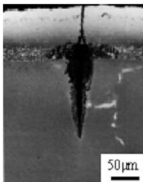
図6 20,000時間使用後のPt-Alコーティング翼に生じた亀裂 (9)
