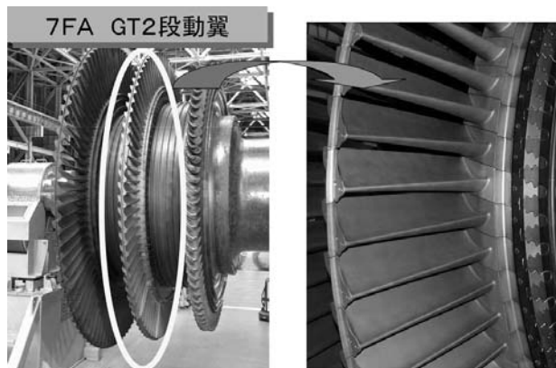
図5 BLE Process™翼の実機組込状況
