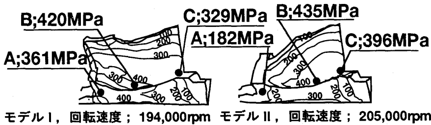
図 12 平均破壊回転速度での応力分布
