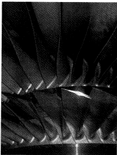
図3 高速、大容量フリースタンド低圧翼列
