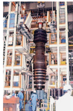
図2 ロータ精密点検
