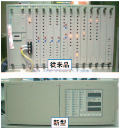
Fig. 21 新旧エンジン制御装置の外観
