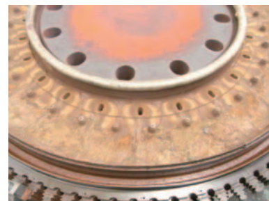
図3 ロータ精密点検（ディスクの状況）
